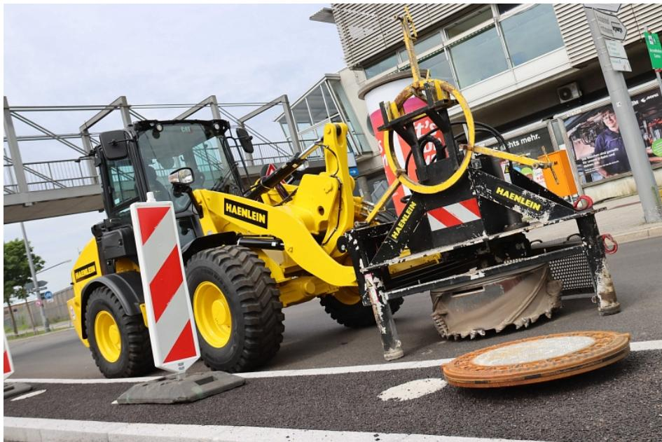
Die runde Bohrkrone mit 980 Millimeter Durchmesser steht bereit, um sich in den Asphalt einzufräsen (Bild: Zeppelin).
