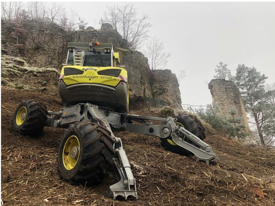
Der Schreitbagger ist für steile Einsätze prädestiniert und wird mit einem Hochleistungshydrauliköl betrieben, um die Maschinenverfügbarkeit hoch zu halten (Bild: Bantleon)
