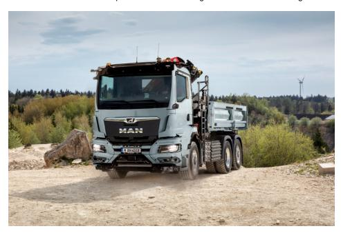
Der vollelektrische »eTGS« 6x2-4 mit Kran- und Kipperaufbau demonstriert die Alltagstauglichkeit batterieelektrischer Lösungen im schweren Baueinsatz (Bild: MAN).
