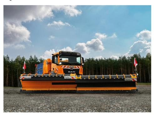
Der stufenlos teleskopierbare Schneepflug »Teplex TK 4080X« kann seine Breite von vier Meter auf acht Meter verdoppeln (Bild: Bucher Wernberg).
