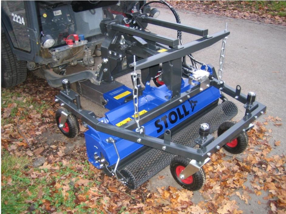
Ausführung für Fahrzeuge mit Zwischenachsabsaugung (Bild: Stoll).
