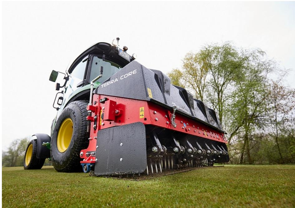
Der »Terra Core 8« ist die branchenweit neueste Pflegemaschine für die oberen zehn Zentimeter der Grasnarbe (Bild: Wiedenmann).
