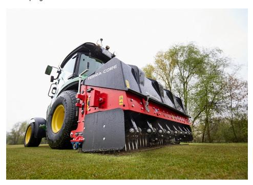
Der »Terra Core 8« ist die branchenweit neueste Pflegemaschine für die oberen zehn Zentimeter der Grasnarbe (Bild: Wiedenmann).
