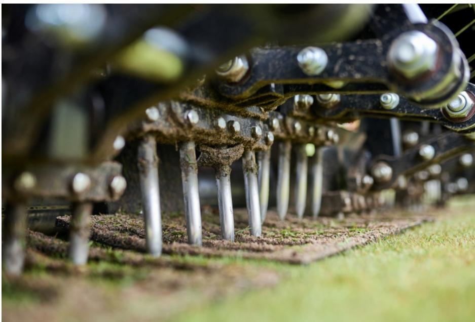
Der Arbeitsbereich von 10 bis 40 cm war bisher die Domäne von Wiedenmann, um dort Verdichtungen aufzubrechen und Wasser besser abzuleiten. Für den darüber liegenden Bereich geht mit dem »Terra Core 8« nun ein neuer Aerifizierer an den Start (Bild: Wiedenmann).
