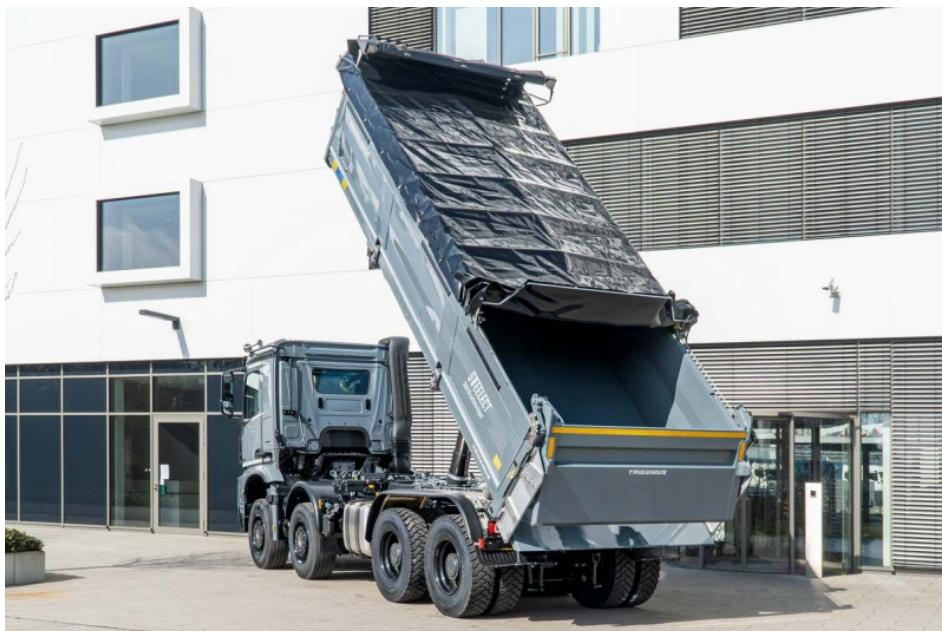
Geeignet ist der »Trigenius«-Aufbau für Lkw mit zwei bis 40 Tonnen Gesamtgewicht
