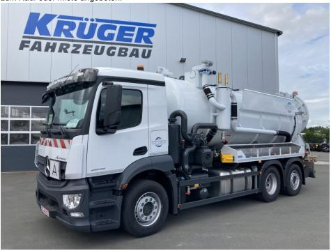
Ein Saug-Druck-Tankfahrzeug aus der Herstellung des Tochterunternehmens Krüger Fahrzeugbau.
