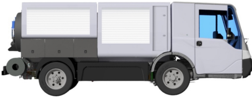
»eCarry«-Fahrgestell mit Saug- und Hochdruckspül-Aufbau (Höhe < 2,0 m).
