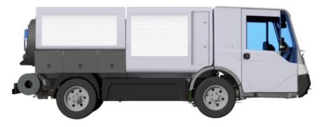
»eCarry«-Fahrgestell mit Saug- und Hochdruckspül-Aufbau (Höhe < 2,0 m).
