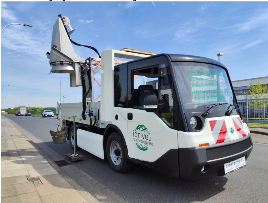
»eCarry«-Niederfahrgestell mit »ProClean«-Frame (Sinkkastenreiniger) der Firma SubTech GmbH.
