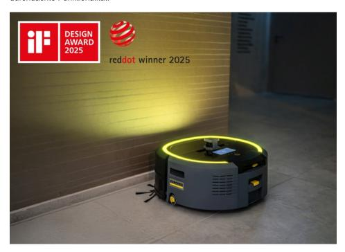
Neben LiDAR gehören auch Ultraschall- und Kollisionssensoren sowie Sensoren zur Glasdetektion, Wandverfolgung und Stufenerkennung zur Ausstattung des Saugroboters (Bild: Kärcher).
