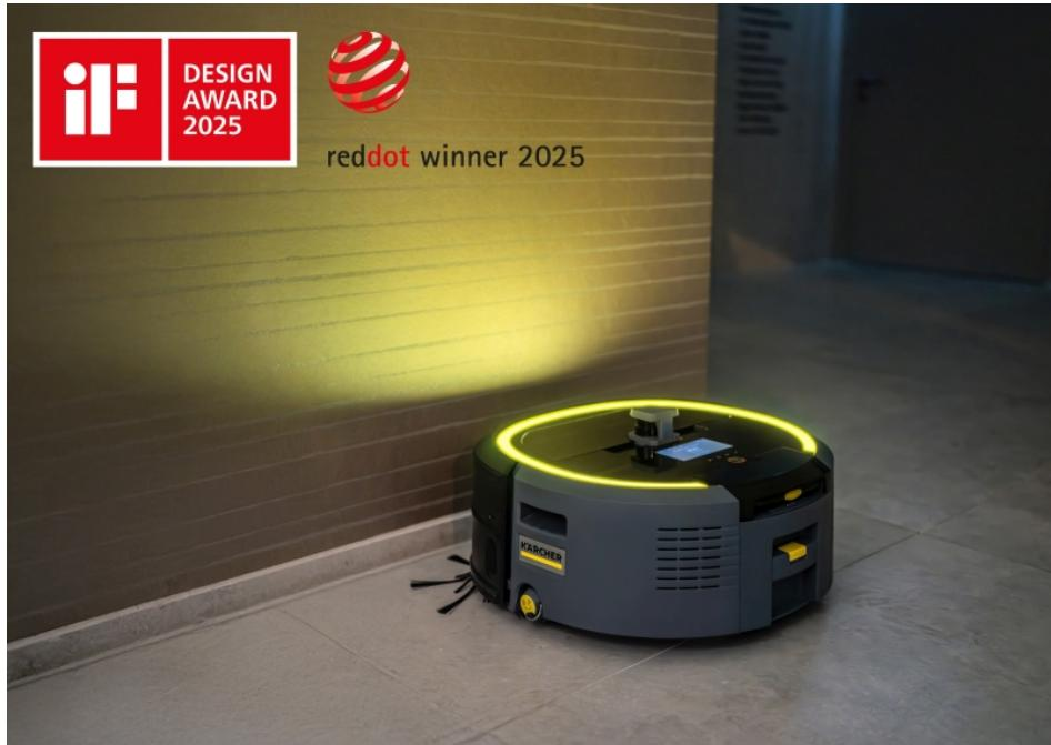
Neben LiDAR gehören auch Ultraschall- und Kollisionssensoren sowie Sensoren zur Glasdetektion, Wandverfolgung und Stufenerkennung zur Ausstattung des Saugroboters (Bild: Kärcher).
