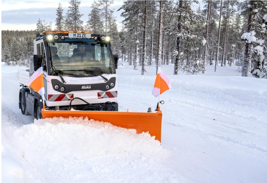
Über den hydraulisch zu betätigenden Frontlift mit DIN-Geräteplatte F4 und die elektrischen und/oder hydraulischen Schnittstellen lassen sich auch bereits vorhandene Anbauten wie Schneeschilder weiterverwenden (Bild: Hako).
