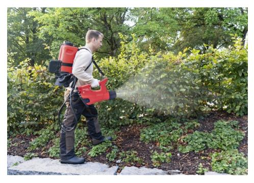
Für eine flächige Ausbringung ist der Flachstrahlaufsatz am effizientesten (Bild: Birchmeier).
