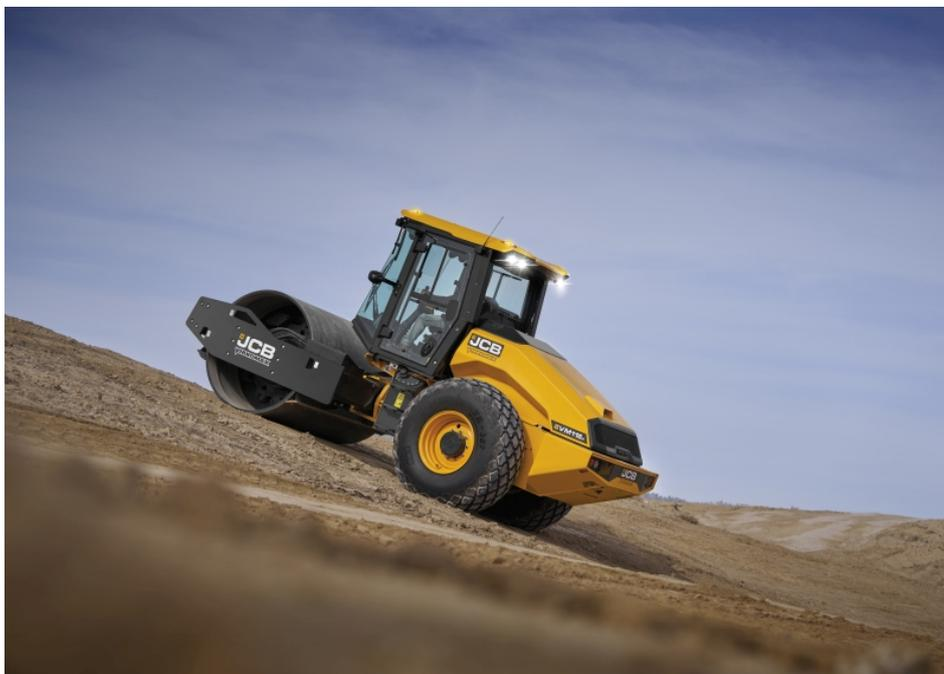
Walzenzug »VM118D«: Der erste Walzenzug über 10 t mit 55 kW EU-Stufe-V-Motor – ohne Diesel-Exhaust-Fluid (Bild: JCB).
