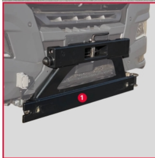
BauTeil 1 - fahrzeugseitige Konstruktion - welcher am Fahrzeug an den dafür vorgesehenen Vorrichtungen fest angebracht und individuell herstellerbezogen konstruiert wird.
