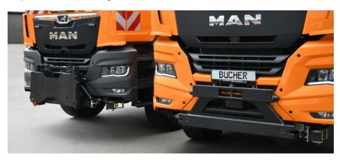
Die neue zweiteilige Frontanbauplatte ermöglicht eine einfache Handhabung. Außerdem bietet sie eine erhöhte Flexibilität. (Bild: Bucher Municipal Wernberg)
