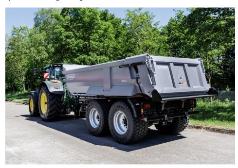
Krampe Erdbaukipper mit hydraulischer Zwangslenkung und einer Außenbreite von 2,55?m (Bild: Krampe).
