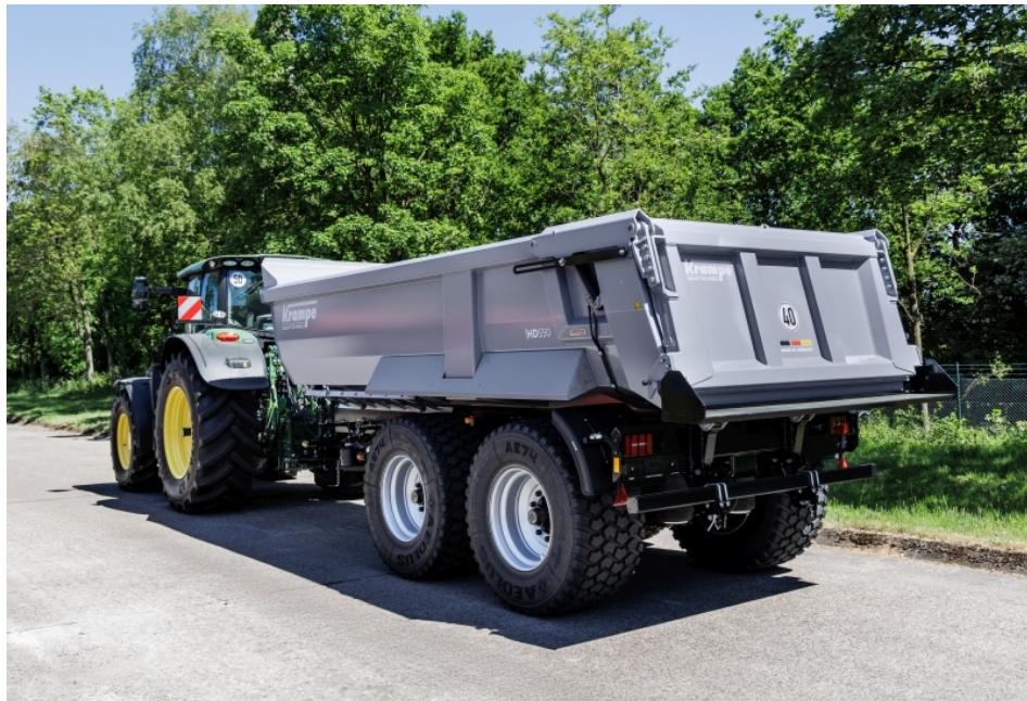
Krampe Erdbaukipper mit hydraulischer Zwangslenkung und einer Außenbreite von 2,55?m (Bild: Krampe).
