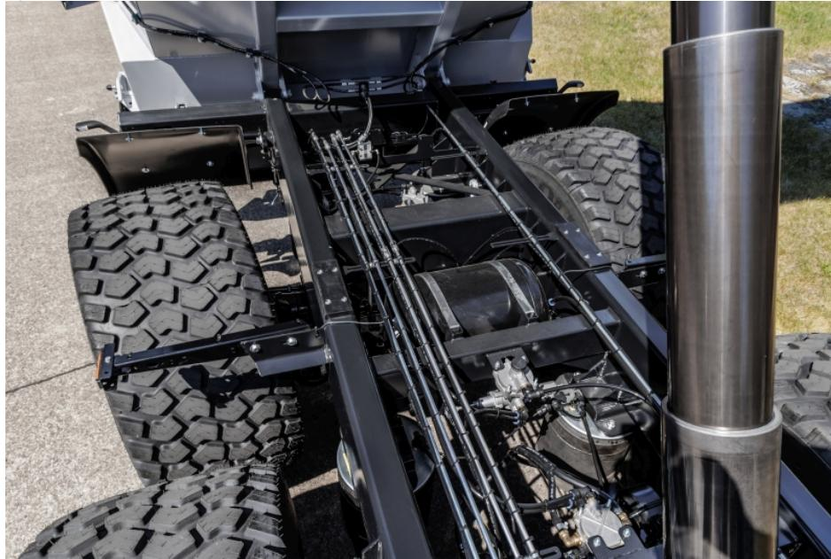
Eine hydraulische Zwangslenkung verbessert die Manövrierbarkeit auf der Baustelle deutlich (Bild: Krampe).
