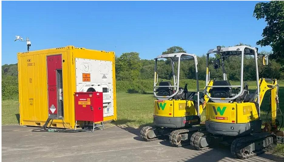
Ein Batteriespeicher mit 400 kWh diente als zentrale Energiequelle (Bild: Zeppelin Rental).
