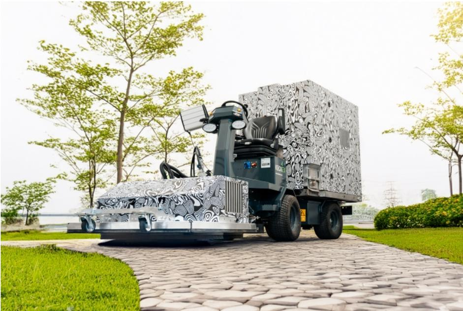
Der »DEEP-CLEAN-HD/450« arbeitet mit heißem Dampf und speziell angeordneten Bürsten. So können Außenflächen ohne Hochdruck behandelt werden (Bild: Keckex).
