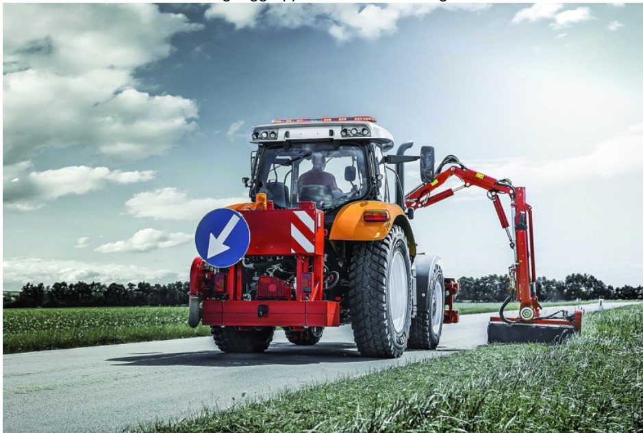
Ein Steyr-Kommunaltraktor mit Auslegermäharm im Einsatz (Bild: CNH/Steyr).
