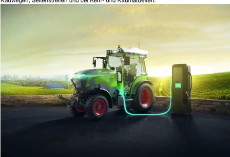
Die CCS2-Steckdose ermöglicht das Laden über Wechselstrom bis 22 kW. Sogar das Schnellladen bis 80 kW über Gleichstrom ist mit dem Elektro-Fendt möglich. (Bild: AGCO Fendt).
