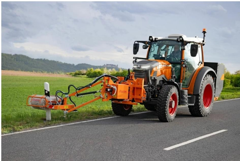
Emissionsfreies Arbeiten ohne Einschränkung – der elektrische »e107 Vario« ist ein vollwertiger Kommunaltraktor (Bild: AGCO).
