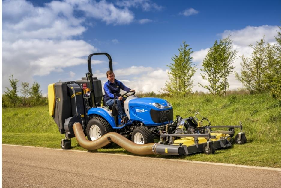
Mähen in der Front, im Heck oder im Zwischenachsabschnitt – mit dem Boomer ergibt sich immer die perfekte Lösung (Bild: CNH / New Holland).
