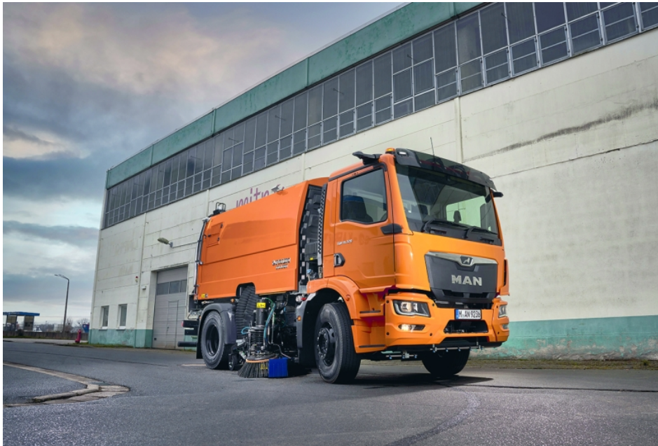
Eine sehr kompakte Kombination stellt die Kehrmaschine aus »TGM 18.320« und »Faun Viajet 6«-Aufbau dar (Bild: MAN).
