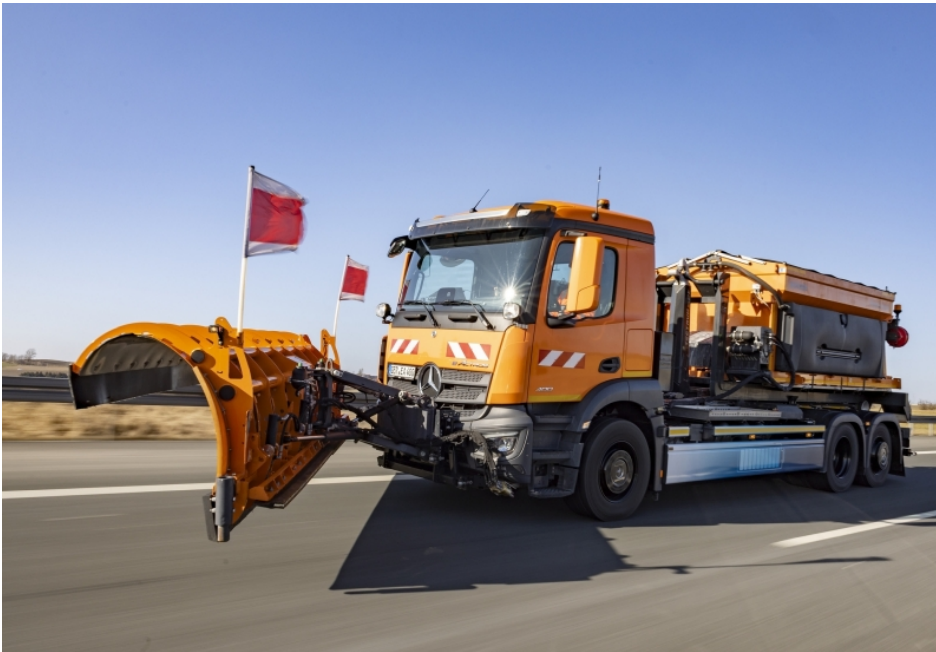
Mercedes-Benz »eActros 400« in Winterdienst-Konfiguration (Bild: Daimler Truck).
