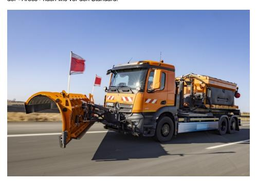
Mercedes-Benz »eActros 400« in Winterdienst-Konfiguration (Bild: Daimler Truck).
