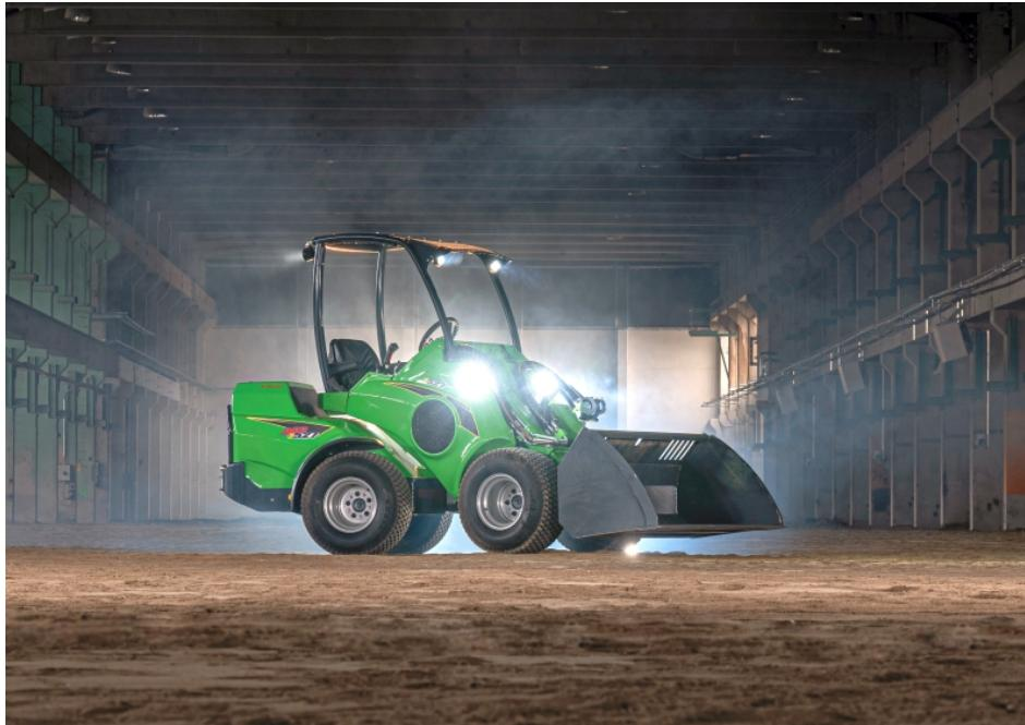
Der emissionsfreie Avant »e527« kann in knapp 90 min wieder komplett „nachgeladen“ werden (Bild: Avant).
