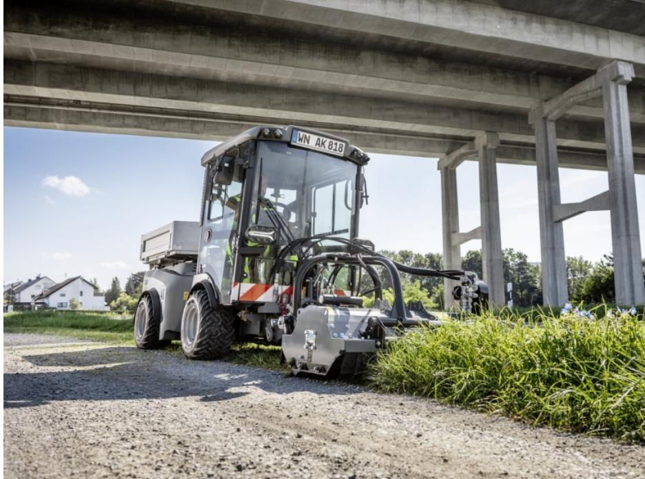
Starke Leistung: Der robuste Frontkraftheber kann selbst schwere Anbaugeräte tragen und antreiben (Bild: Kärcher Municipal).
