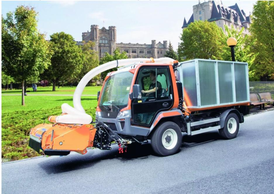
Eine Besonderheit des Kommunaltransporters »Unitrac« sind die 4-Rad Lenkung und eine ausgezeichnete Zugkraft – hier in einem typischen Kommunaleinsatz (Bild: Lindner).
