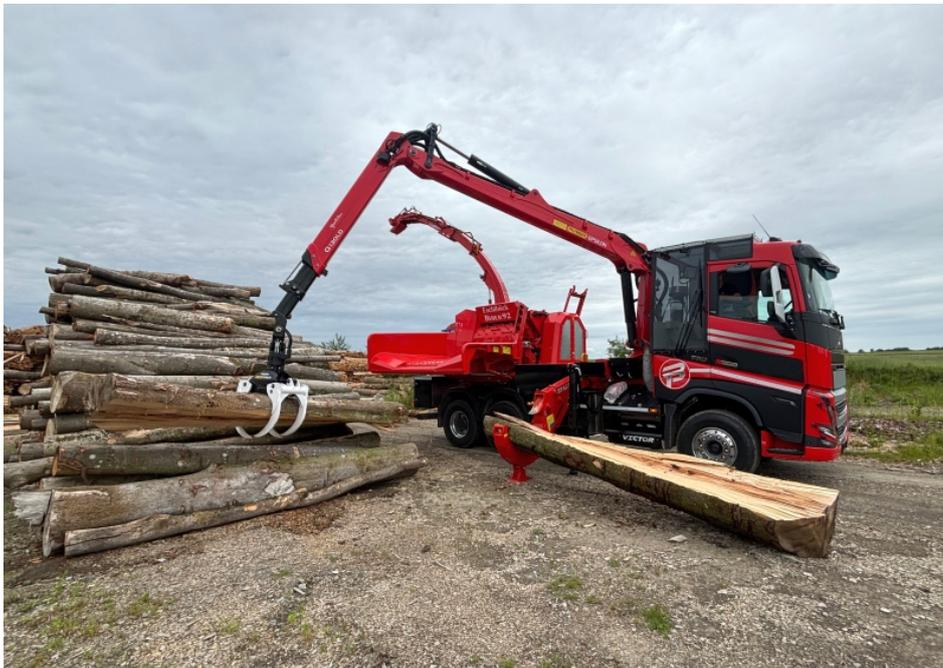
Eschlböck »Biber 92 Victor« mit Kranbeschickung und »Spaltbiber« (Bild: Eschlböck).
