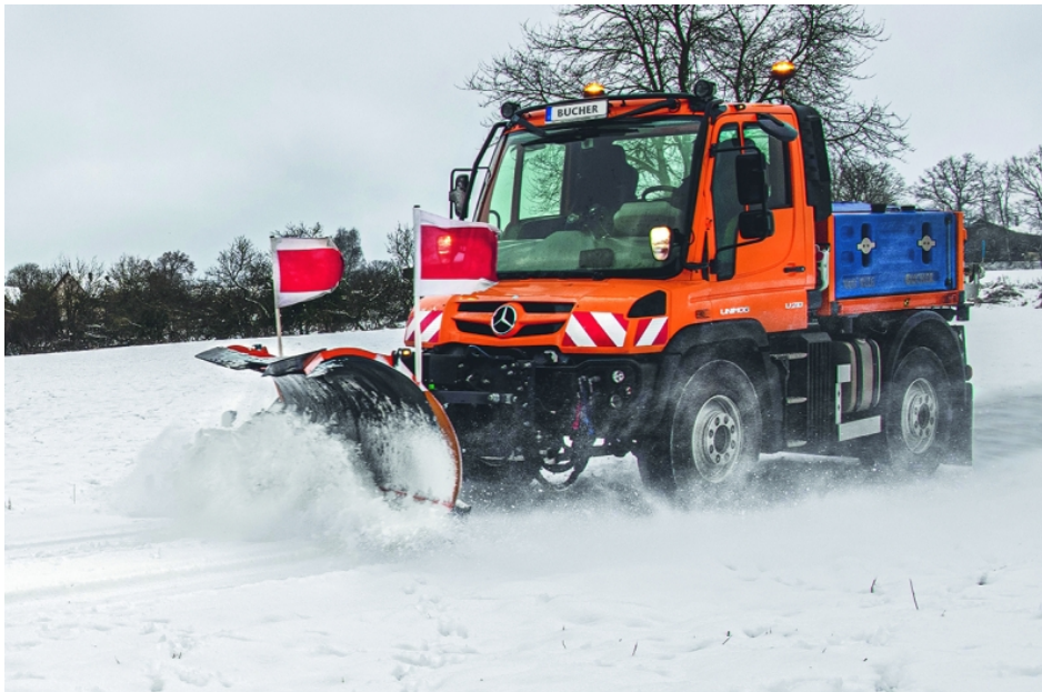
Unimog U218 mit »Unix«-Schneepflug (Bild: Bucher Municipal).
