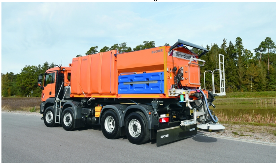
Kombistreuautomat »Icebear W« mit 10.500 l Sole und 6 m 3 Trockenstoff (Bild: Bucher Municipal).
