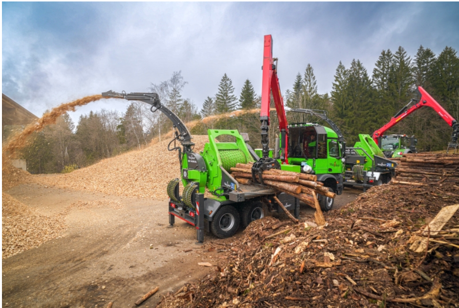
Lkw-Hacker »Heizohack HM 14-860 KL« in Aktion (Bild: Heizomat).
