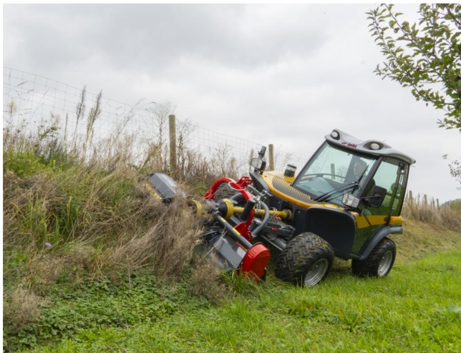
Aebi »TT 211+« im Mulcheinsatz – kompakt, wendig und sicher auch in steilen Böschungen. Wie alle Terratrac-Modelle überzeugt er durch Bodenschonung, leistungsstarke Hydraulik und vielseitige Einsatzmöglichkeiten (Bild: Aebi Schmidt).
