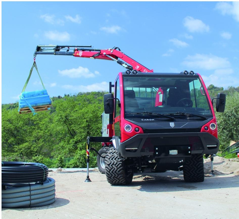
Der Caron »CTS« bei der Arbeit: Der optionale Kran kann an in der Zentral- oder Heckposition, auf einer absetzbaren Pritsche oder auf einem verstärkten Rahmen montiert werden (Bild: Caron).
