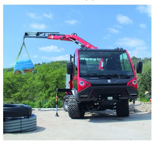
Der Caron »CTS« bei der Arbeit: Der optionale Kran kann an in der Zentral- oder Heckposition, auf einer absetzbaren Pritsche oder auf einem verstärkten Rahmen montiert werden (Bild: Caron).
