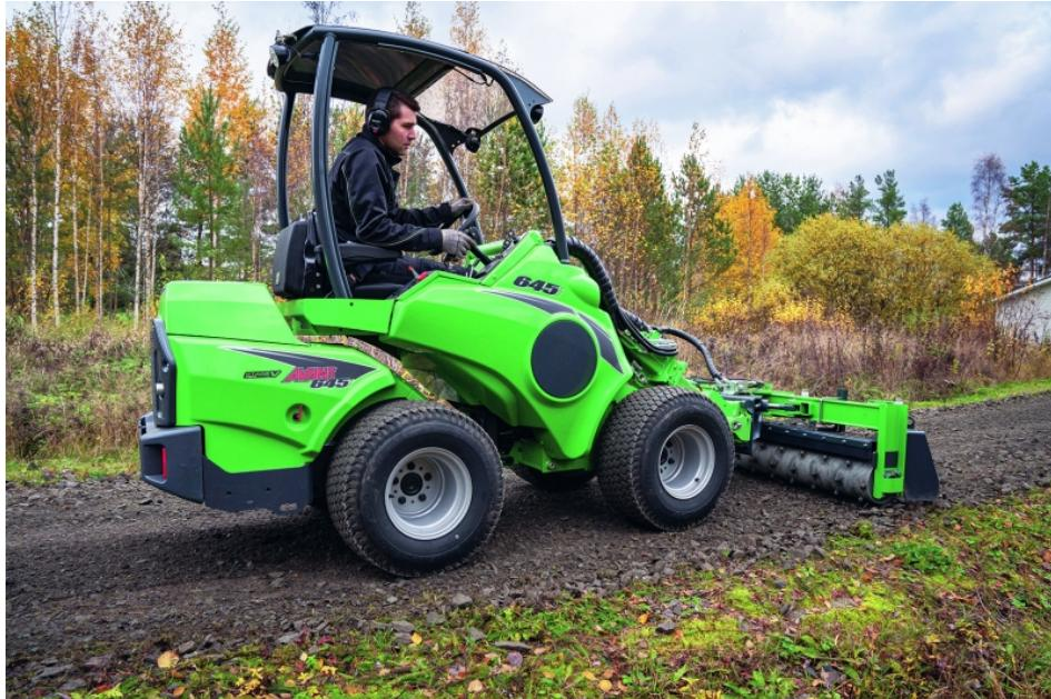
Ein Avant »645i« mit Anbau eines Power-Rechens zur Bodenbearbeitung (Bild: Avant).
