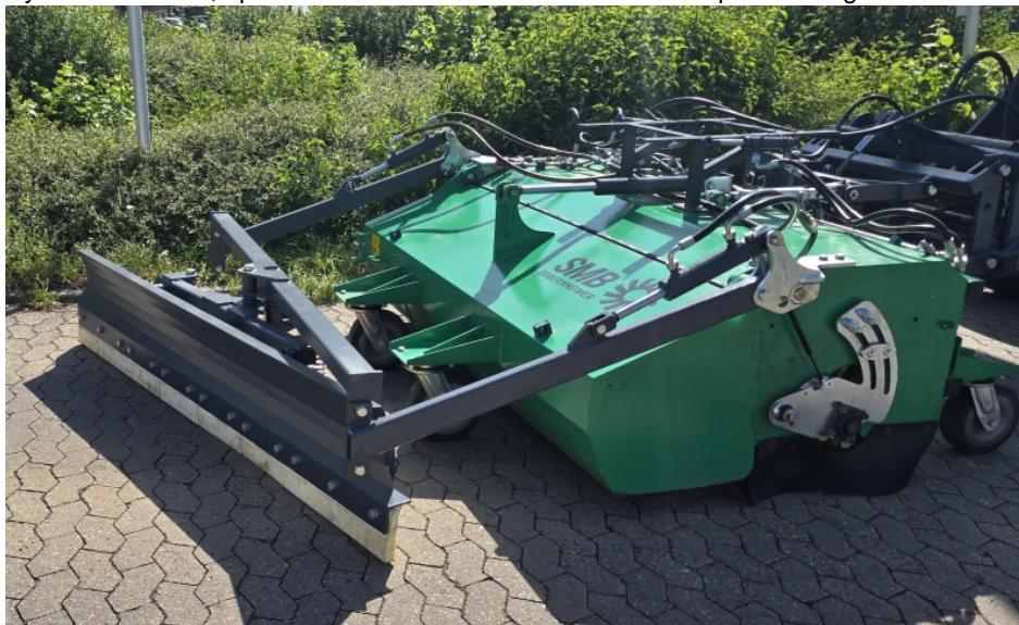
Baukehrmaschine »BKM 100« mit Option Leichtgutschubvorrichtung (Bild:
