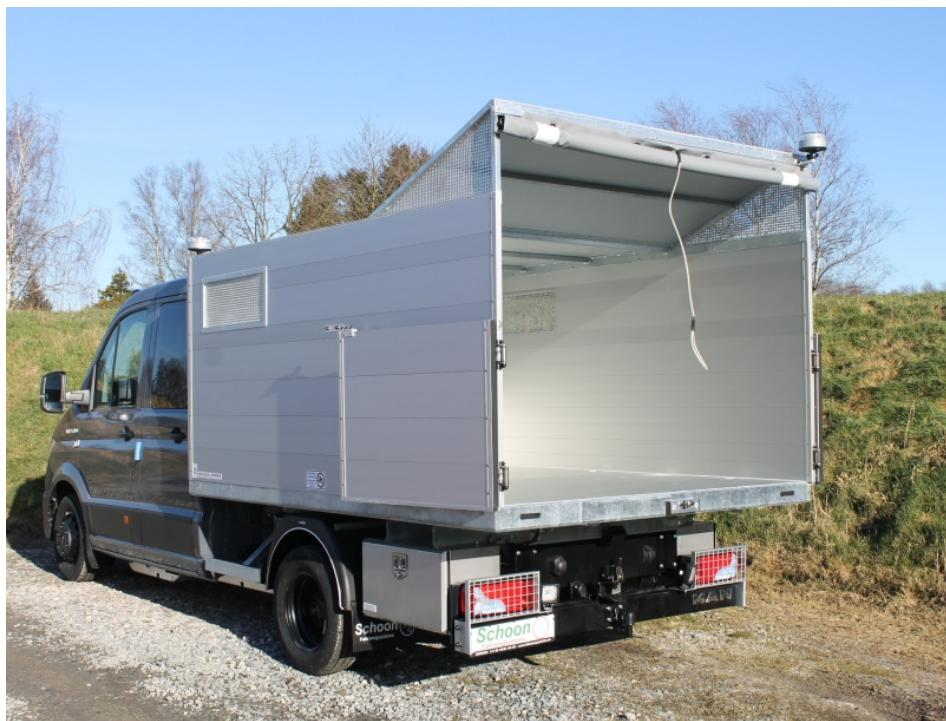
Schoon-Häcksleraufbau mit Gitter und Planenrolltor am Heck sowie RKL und Werkzeugbox (Bild: Schoon).
