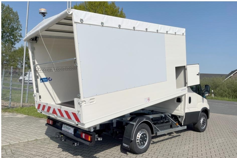
Ein »Müllsammler« mit Heckkipper und Heckplane, Rundumkennleuchte und Arbeitscheinwerfer (Bild: Schoon).
