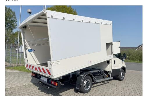
Ein »Müllsammler« mit Heckkipper und Heckplane, Rundumkennleuchte und Arbeitscheinwerfer (Bild: Schoon).
