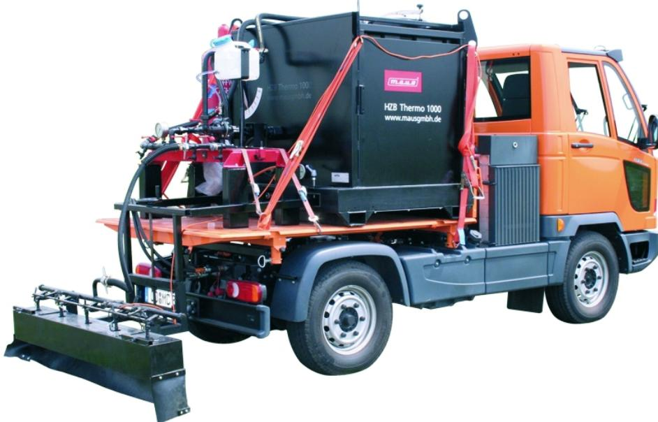
Der »HZB-Thermo 1000« hat ein Fassungsvermögen von 1000 l und wird als Anspritzgerät auf einem Anhänger oder Trägerfahrzeug verwendet (Bild: Maus).
