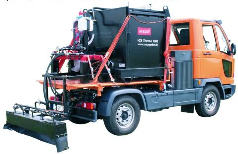
Der »HZB-Thermo 1000 « hat ein Fassungsvermögen von 1000 I und wird als Anspritzgerät auf einem Anhänger oder Trägerfahrzeug verwendet (Bild: Maus).
