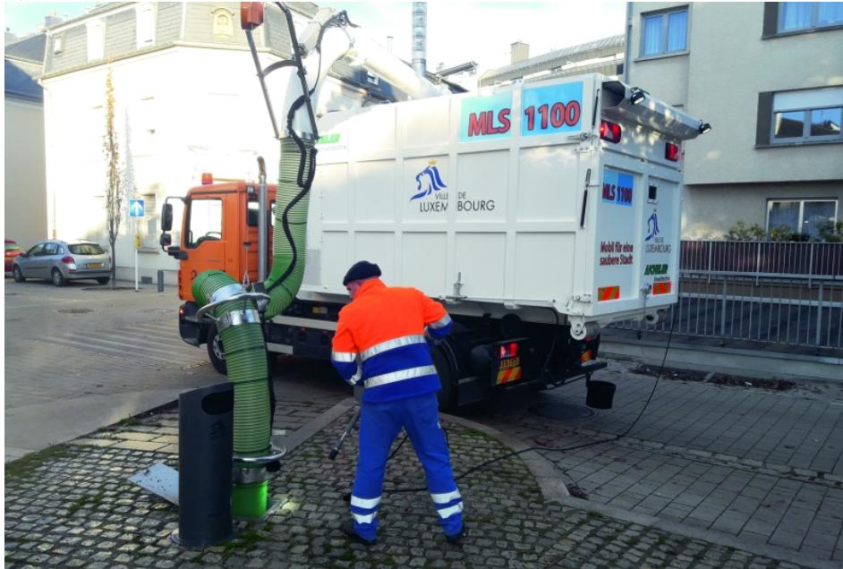
Die Reinigung der Einwurfröhre erfolgt gründlich mithilfe einer Hochdrucklanze, nachdem der unterirdische Sammelbehälter abgesaugt wurde (Bild: Aicheler).
