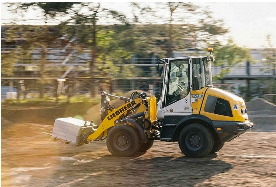
Mit dem »L 507 E« ist Liebherr in den Markt für elektrisch angetriebene Radlader eingestiegen. Die Batterien sollen genügend Energie für acht Stunden Arbeit haben (Bild: Liebherr).
