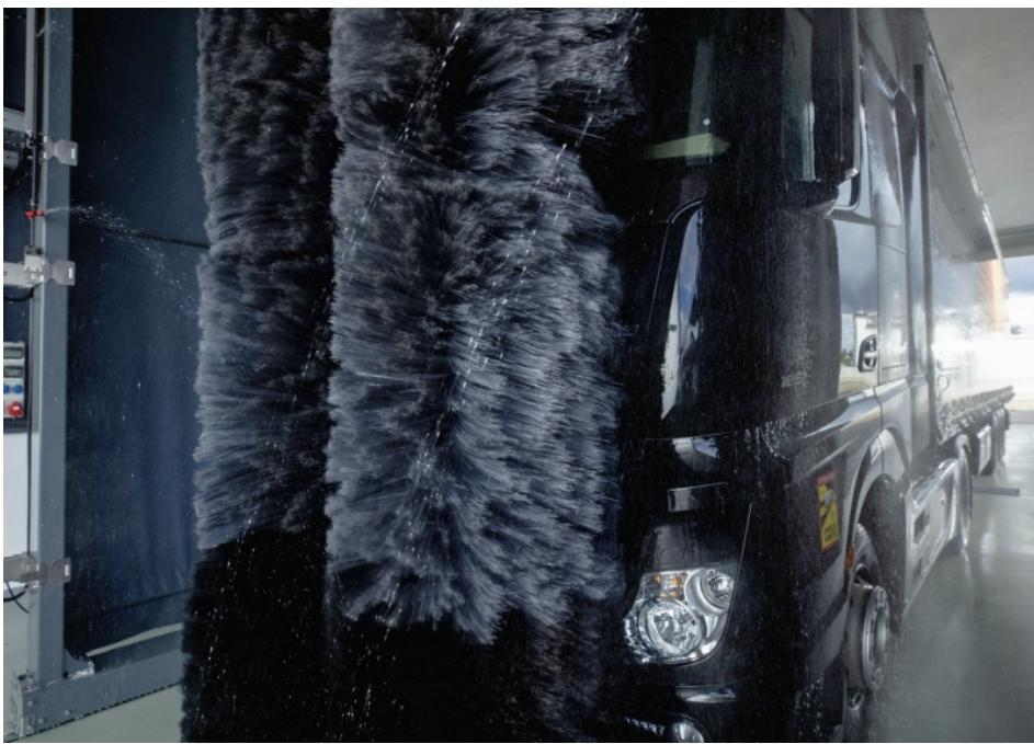
Nutzfahrzeuge mit unterschiedlichen Formen können dank eines neuen Bürstenaufhängungssystems passgenau gereinigt werden (Bild: Kärcher).
