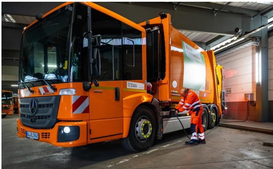
Im täglichen Betrieb legen die Fahrzeuge durchschnittlich rund 80 Kilometer zurück, in Einzelfällen über 100 Kilometer. Drei Batteriepakete mit jeweils 112 kWh installierter und rund 97 kWh nutzbarer Kapazität ermöglichen im Einschichtbetrieb Touren ohne Zwischenladen. Durch Rekuperation im Stop-and-go-Betrieb wird Energie zurückgewonnen. Das »Multimedia-Cockpit Interactive« informiert über Batteriestatus, Verbrauch und Reichweite.
