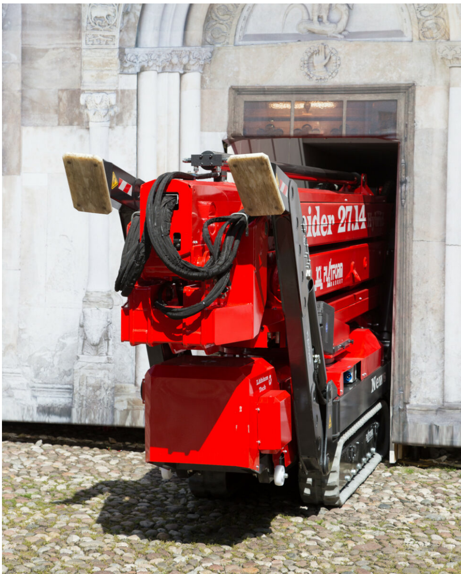
Die Raupenarbeitsbühne »Spider27.14« kombiniert 89 Zentimeter Breite mit 27,01 Metern Arbeitshöhe und bis zu 15,11 Metern Reichweite (Bild: KUNZE).
