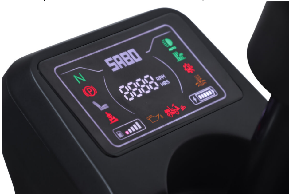
Das LED-Display stellt relevante Betriebsinformationen übersichtlich bereit. (Bild: SABO-Maschinenfabrik GmbH)
