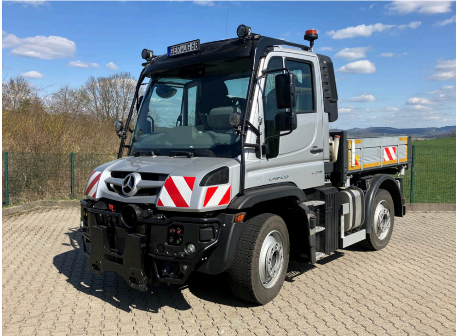
Das Einstiegsmodell Unimog »U 219« mit niedriger Beladehöhe. (Bild: Daimler Truck AG)
