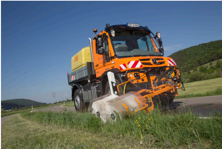
Der Unimog »U 530« mit Leitpfostenwaschgerät. (Bild: Daimler Truck AG)
