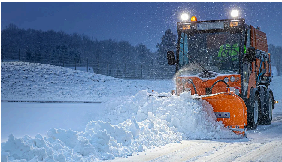
Der Keil-Vario-Pflug der Fiedler-Baureihe »FKP« im Wintereinsatz. (Bild: Fiedler)
