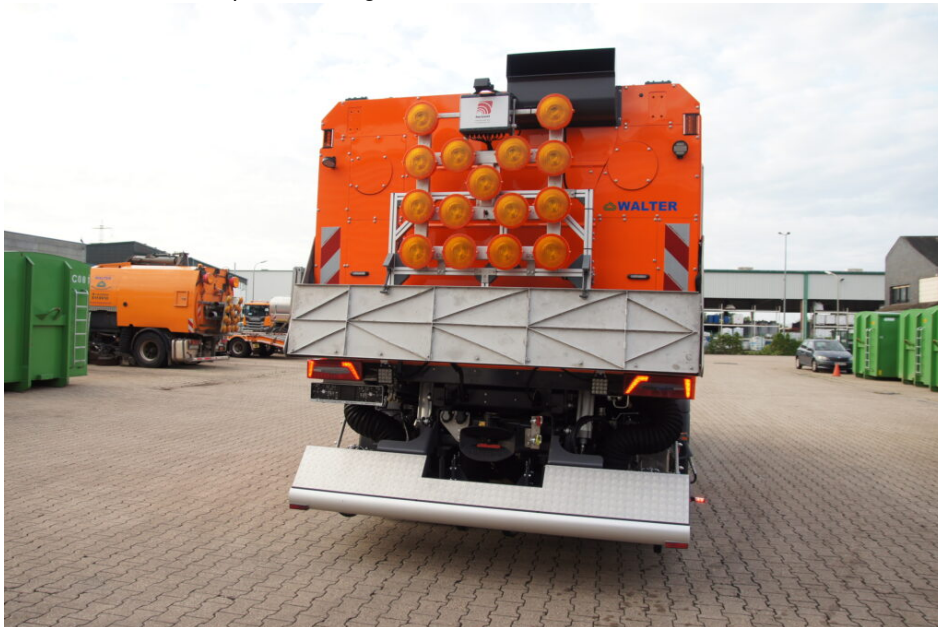
Die Hochleistungs-Kehrmaschine »Walter 8 Series« von Walter & Co. kombiniert einen 8,2 m 3 großen Schmutzbehälter mit kompakter Bauweise und einem Radstand ab 3,6 m. (Bild: Walter & Co.)
