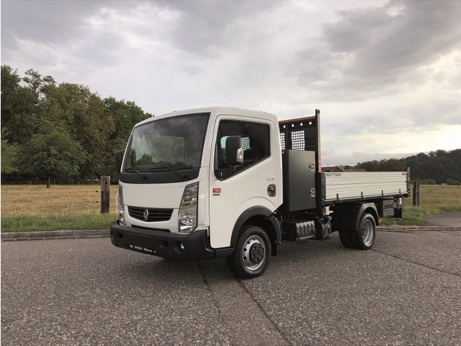
Der leichte Lkw Renault Maxity erreicht eine maximale Nutzlast von 2680 kg.
