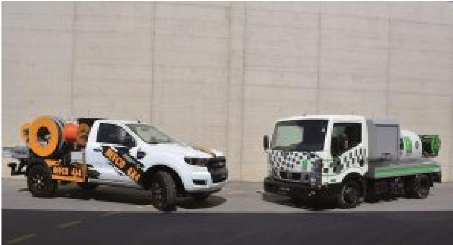
Das kombinierte Saug-Spülfahrzeug DYNA-Combi ist mit seinem kompakten Aufbau, seiner großen Leistungsfähigkeit und dem geringen Lärmpegel eines der Aushängeschilder des Dietmar-Kaiser-Produktportfolios. Das Fahrzeug verfügt über eine 2-Joystick-Steuerung, welche der einfachen und sicheren Gerätesteuerung dient.
