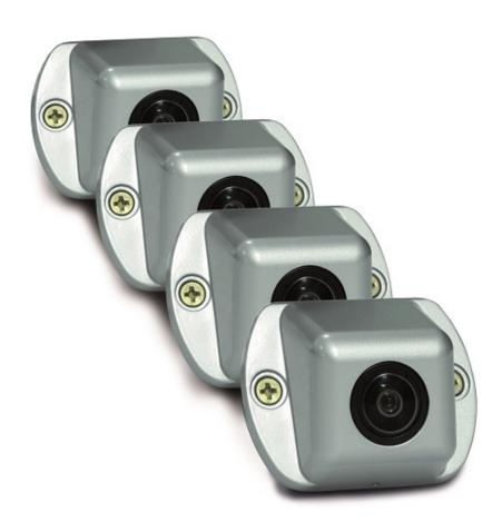
Bei sehr großen oder komplexen Fahrzeugen wie Schwerlastzugmaschinen gibt es besonders viele uneinsehbare tote Winkel, die beim Rangieren die Gefahr einer Kollision bergen. Um das Risiko von Personen-, Sach- und Maschinenschäden zu minimieren, legen die europäischen Richtlinien 2003/97/EG und 2007/38/EG daher fest, dass Lkw
