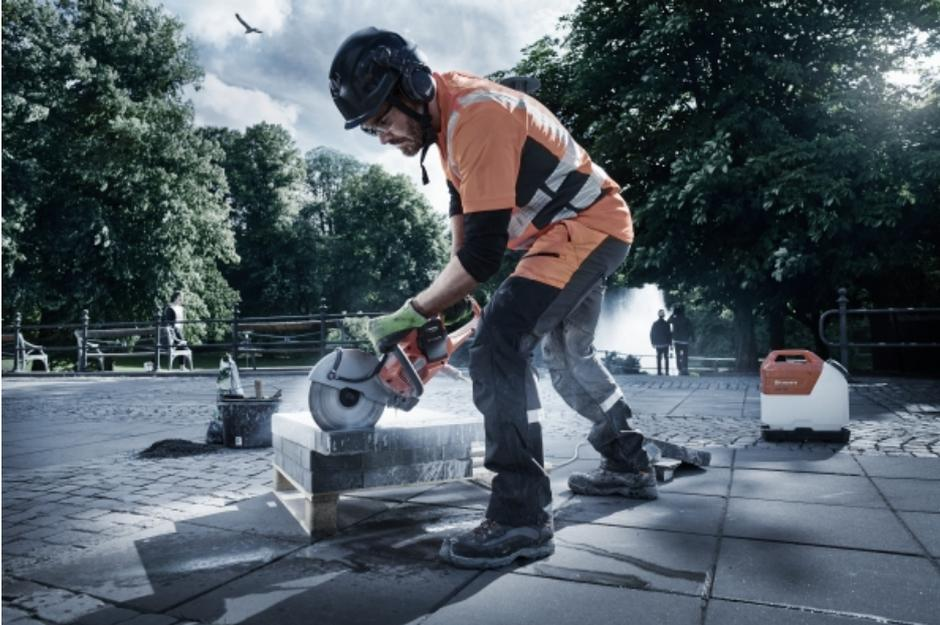
Der Husqvarna Akku-Trennschleifer K 535i schneidet auch bei leichteren Betonarbeiten kraftvoll, kabellos und abgasfrei.
