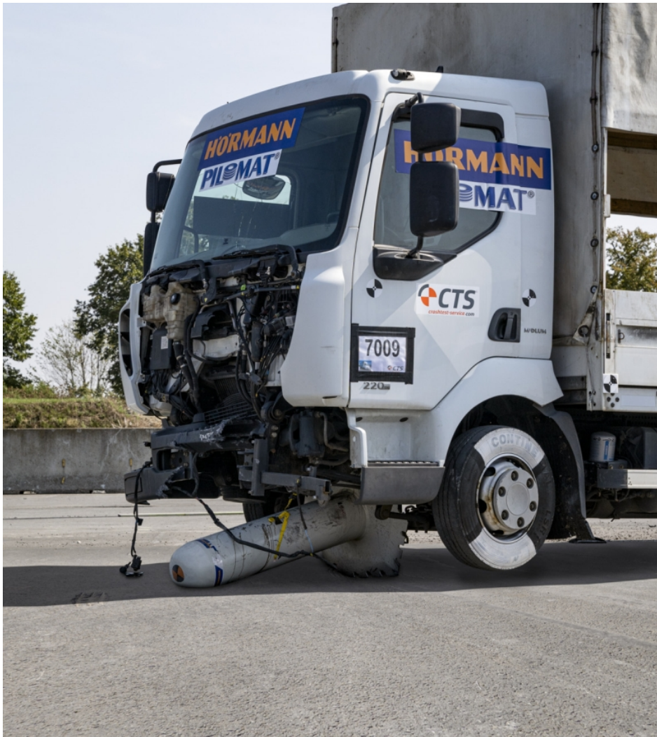
Die Wirkung des OktaBlocks wurde in verschiedenen Crash-Tests nachgewiesen. Bild: Hörmann
