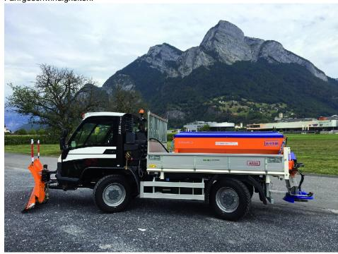
Neuer Motor nach der Norm Euro VI d und verfeinerte Technik unterscheiden den VT »Next Generation« vom Vorgänger.
