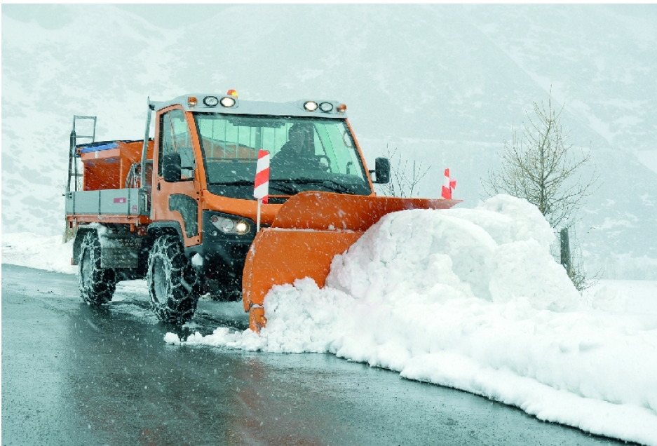
Kommunal-Transporter Viatrac mit Schneepflug und Schmidt-Aufbaustreuer beim Winterdienstesatz.
